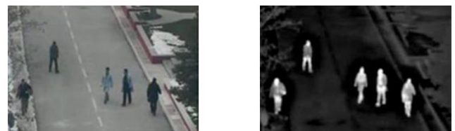
(a) Gündüz görüş kamerası (b) Termal kamera Resim 2. Gündüz görüş kamerası ile Termal kameraların karşılaştırılması (20)
