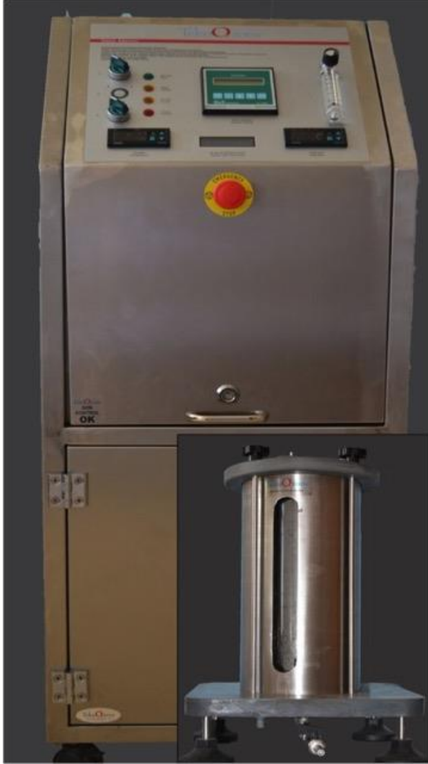
Resim 2. Ozonlu Su Jenaratörü ve Tankı
